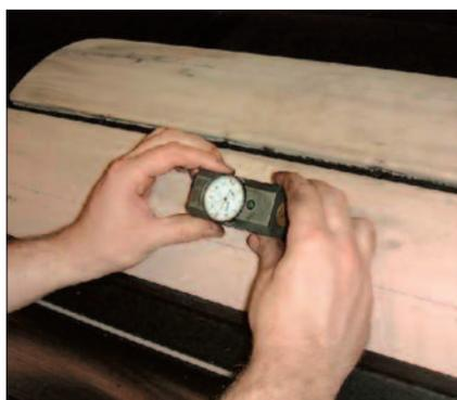
Usare un calibro per caucciù per misurare l'altezza del caucciù sul cilindro di stampa.
