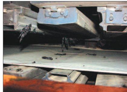
*I detriti di carta e inchiostro possono formare accumuli duri e aguzzi che sono proiettati fuori dalle fessure delle barre soffianti, dando origine a imbrattamenti e rotture del nastro.* Foto MEGTEC.
