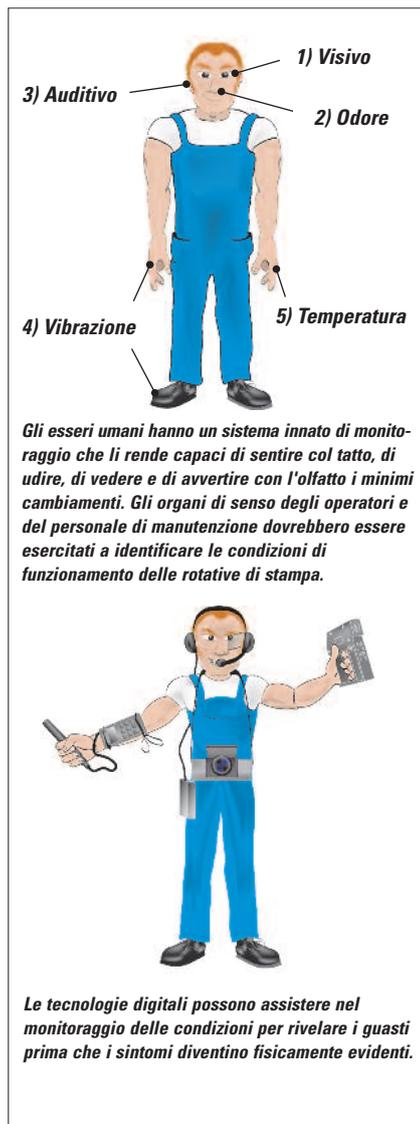
**Monitorare i componenti e rilevare già dal loro inizio le caratteristiche delle avarie (maggiore vibrazione, temperatura di funzionamento, consumo di potenza, cambiamento delle condizioni dell'olio) permette di programmare le riparazioni ancor prima della rottura.**
