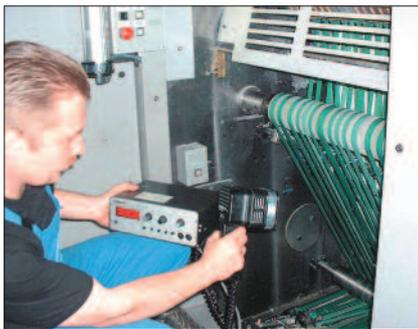
Lo stroboscopio è uno strumento utile per contribuire a identificare i problemi di funzionamento su un'attrezzatura in moto.
