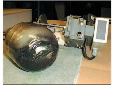
*L'accumulo di sporco sul galleggiante dello stabilizzatore dell'alcol ne fa aumentare il peso e può modificare il contenuto di alcol nella soluzione di bagnatura.*
