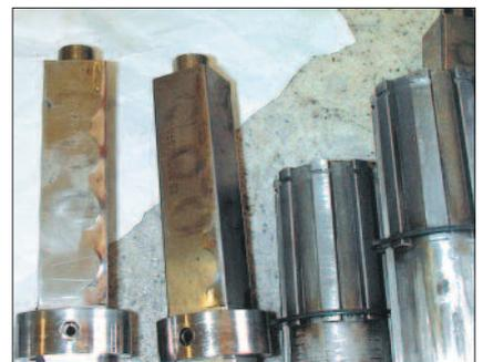
**Il risultato della mancata manutenzione del mandrino è una grave usura che richiede una sostituzione molto prematura degli elementi.** Foto MEGTEC.
