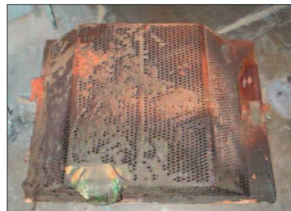
*La carta che si attacca alla retina filtrante della ventola di alimentazione si brucia e si disintegra in fini particelle che attraversano la retina e passano nelle barre pneumatiche, causando una caduta di pressione e macchiature.* Foto MEGTEC.
