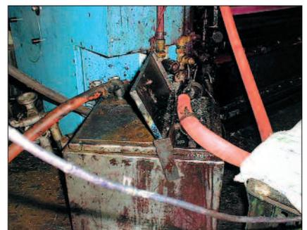
*Sovraccarico di un serbatoio intermedio caratterizzato da scarsa manutenzione.*
