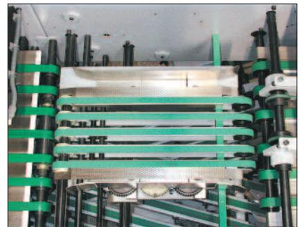
*Controllate le cinghie con regolarità per usura, incrinature e corretta tensione. La sottotensione riduce la potenza di trasmissione, mentre la sovratensione danneggia i motori di azionamento. Foto Müller Martini.*
