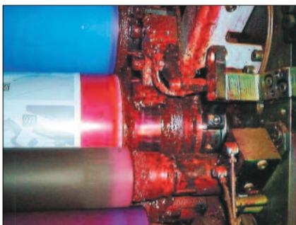
**Gli accumuli di residui di inchiostro e di carta sono una delle cause principali di fermate non programmate e di malfunzionamenti. La superficie dei supporti dei cilindri deve essere sempre tenuta pulita e lubrificata per prevenire l'usura prematura.** Foto manroland.
