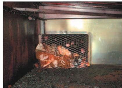
*Se la carta che si attacca alle retine filtranti non viene asportata, brucia e si disintegra in fini particelle che provocano l'avaria del pressostato, fermando la produzione o causando condensazione.* Foto MEGTEC.
