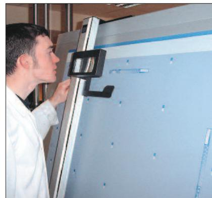
*L'ispezione della lastra costituisce il controllo chiave della qualità per ridurre i tempi passivi della rotativa. Foto KPG.*
