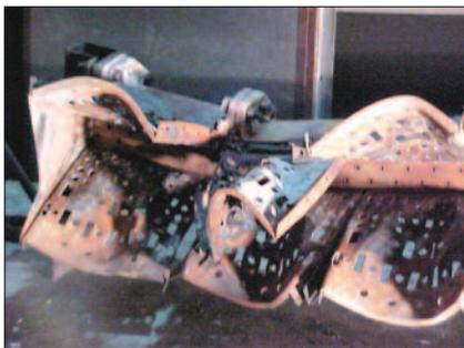
Una scarsa manutenzione del bruciatore e/o una non corretta regolazione della miscela aria-gas possono distruggere il bruciatore. Foto MEGTEC.
