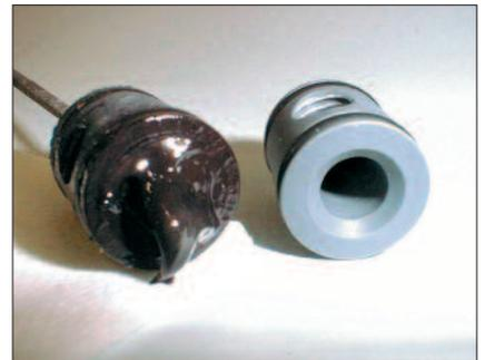
*Un ugello dell'eiettore in linea contaminato con inchiostro, sia per l'uso di un errato elemento di filtro, sia per scarsa manutenzione.*
