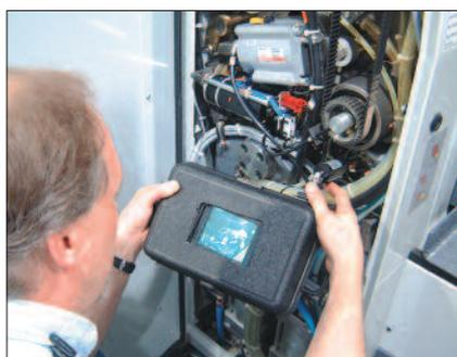
**Alcuni stampatori e i loro fornitori usano una 'web cam' digitale con una trasmittente senza fili e un collegamento Internet a banda larga per identificare e risolvere con maggiore rapidità i problemi della rotativa da centri remoti di servizio. Questo esempio illustra il Service Vision della manroland.**
