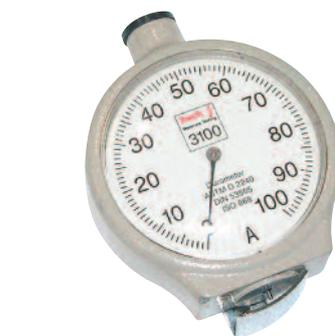
**Usare soltanto strumenti di misura della durezza conformi a DIN EN ISO R868. Per ottenere una lettura precisa è necessario tenere verticalmente lo strumento ed effettuare la lettura dopo 3 secondi di attesa.**
