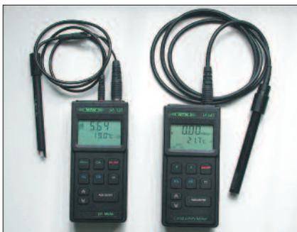
Gli strumenti di monitoraggio del sistema di bagnatura comprendono un misuratore digitale di conducibilità, un misuratore di pH e un termometro a sonda (i dispositivi digitali sono più precisi e più facili da calibrare), un idrometro per testare la percentuale di PA e un tester della durezza dell'aria.
