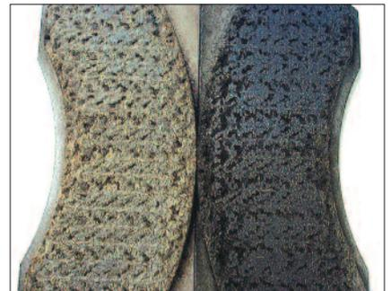
**I cuscinetti del freno usurati causano rotture del nastro e problemi di funzionamento. Cambiarli quando si avvicinano allo spessore minimo raccomandato.** Foto MEGTEC.
