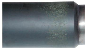
**Rulli danneggiati a causa di regolazioni non uniformi che hanno aumentato notevolmente la temperatura di funzionamento.** Foto Böttcher.
