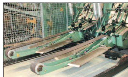
Pulire le guide del nastro trasportatore a bilanciere per evitare danneggiamenti alle cinghie di tensione della stazione portarotoli.
