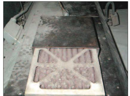
*La polvere intorno alla rotativa è aspirata nell'armadietto elettrico e trattenuta dal filtro. Se il filtro non è pulito, i componenti elettrici si surriscaldano, danneggiandosi, e possono perfino causare un incendio. Foto MEGTEC.*
