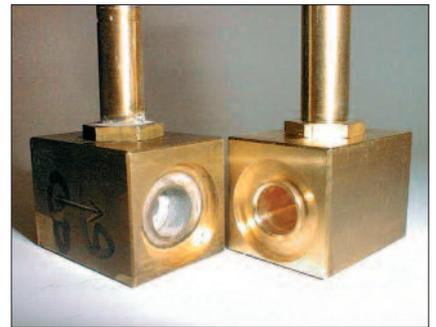
*Corrosione di parti meccaniche derivante dall'uso di un additivo non corretto o aggressivo o di alcol di bassa qualità.*
