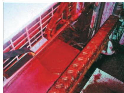
*Protezioni a squadra sporche con solchi di serraggio male impostati lasciano gocciolare l'inchiostro causando macchiature e rotture del nastro. Foto manroland.*
