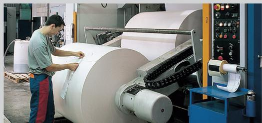
Si raccomanda la preparazione su portarotoli se non è stato installato un sistema di movimentazione della bobina, poiché ciò riduce al minimo i danni, gli scarti ed è ergonomicamente più efficiente.
