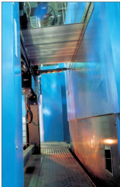
Les sécheurs sont conçus pour chauffer la bande le plus rapidement possible sans l'abîmer et fournir un temps de pose suffisant pour éliminer les solvants à la température de séchage requise. Les sécheurs sont normalement dimensionnés pour les papiers couchés les plus lourds, une vitesse d'impression élevée et une couverture d'encre importante. Ces spécifications varient entre les fabricants de presses mais aussi en fonction des applications.
