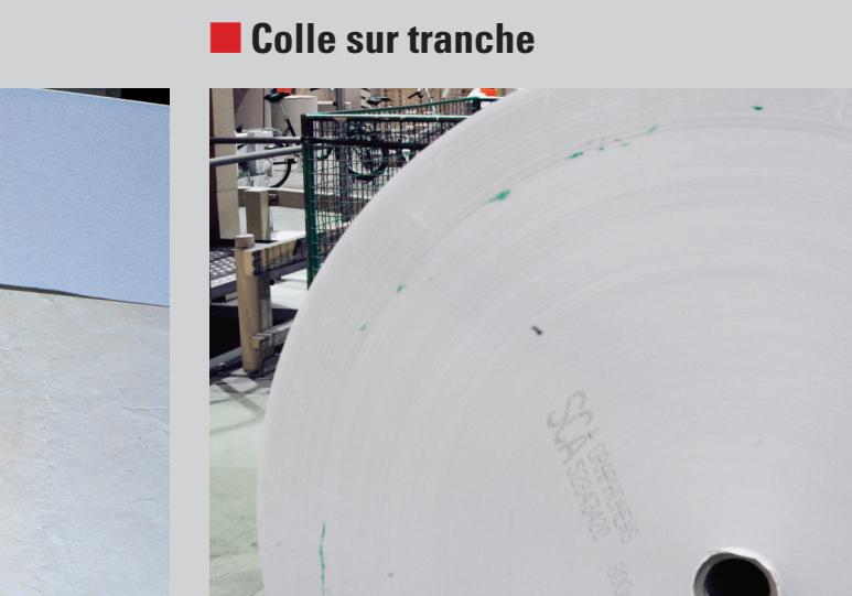
Cause par une erreur d'emballage, de sorte que la colle vient en contact avec la trame de la bobine, ou encore par une pénétration locale d'eau dans l'emballage, avec formation de petites taches aux endroits où les spires de papier sont collées ensemble.
