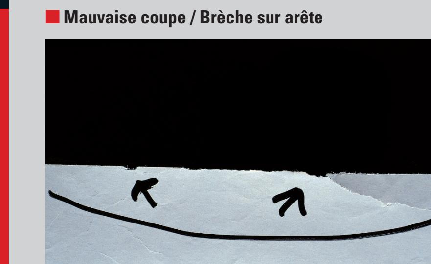
Généralement occasionné par un couteau mal réglé, déformé ou mal coupé donnant une apparence écaillée et gaufrée aux bords. La biseau sur arête peut se déchirer si le bord de la bande est irrégulier ou rugueux. Des brèches sur arête peuvent aussi se produire quand l'arête de la bobine a été heurtée ou abimée. De la poussière de découpe est quelquefois présente, pouvant s'accumuler sur les bords externes du blanclet, causant la détérioration de l'impression ou l'endommagement du caoutchouc.
