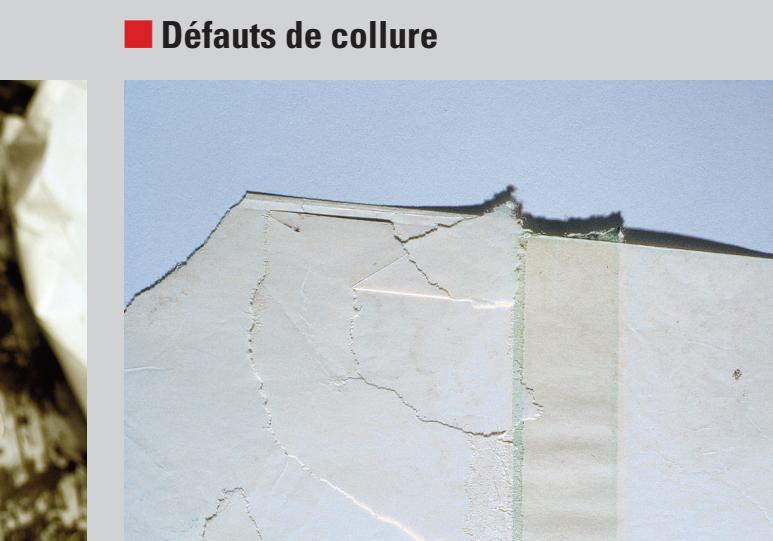
Mauvaise collure: l'adhésif est mal positionné et colle à la spire de papier du dessous. Collure débordante: les bandes ne sont pas alignées lors de la collure et le papier déborde sur la trame. Collure adhérente: l'adhésif n'est pas couvert par le papier et colle sur la spire de papier causant une casse.
