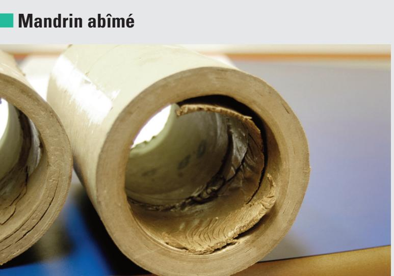
Ce défaut peut être dû à un manque de pression dans les broches du dérouleur, à la mise et remise de la bobine sur les bras du dérouleur ou à la mauvaise qualité du mandrin.
