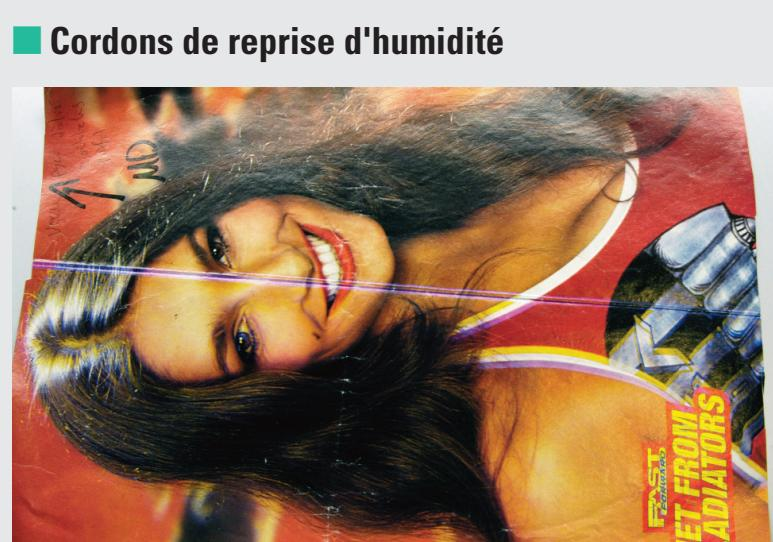
Formation de plis autour de la bobine dans le sens machine résultant de l'absorption de l'humidité du papier et l'humidité ambiante. Ces plis sont occasionnés par un déséquilibre entre l'humidité du papier et l'humidité ambiante.
