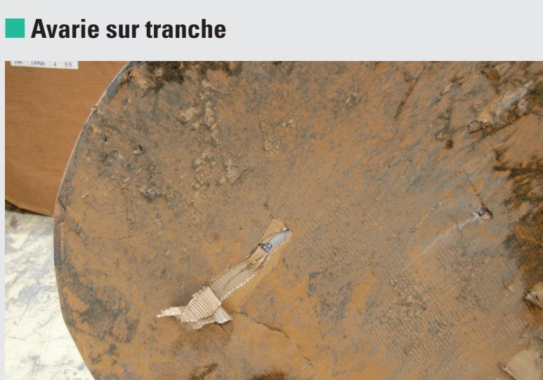
Déchirures ou coups dans la trame de la bobine occasionnés par le stockage sur une surface rugueuse ou sale ou par une manutention sans précaution au-dessus d'une surface irrégulière.
