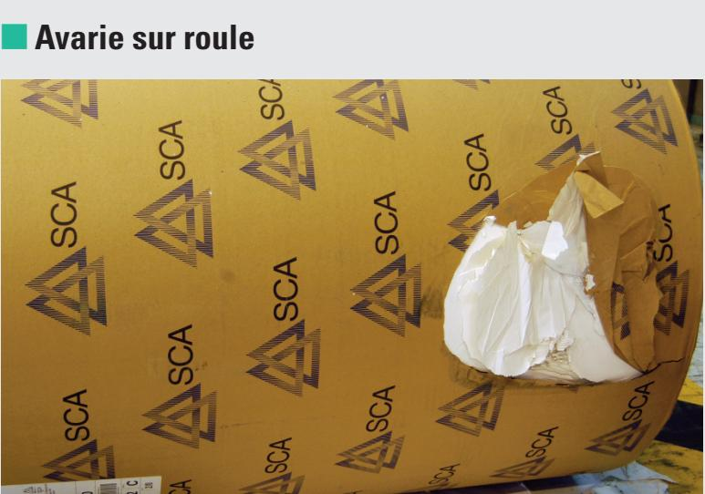
Perforation de l'emballage et du papier suite la manutention de la bobine sans précaution: friction entre deux bobines, impact d'un objet tranchant, mauvaise pression des pinces de serrage du chariot élévateur.
