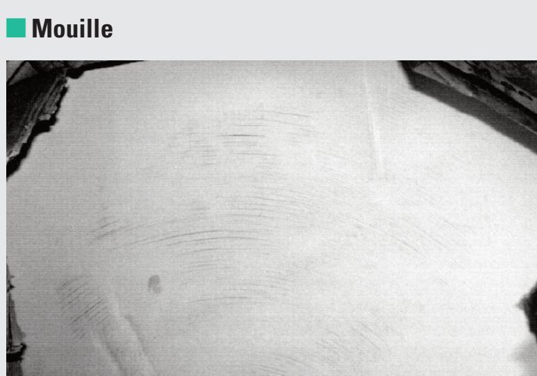
Lorsque des zones saturées d'eau séchent, plusieurs spires de papier collent entre elles. Ce défaut n'est pas toujours visible quand la bobine est emballée, mais apparaît sous forme de vide dans l'enroulement des spires. Ne pas confondre avec la présence de colle sur trame.
