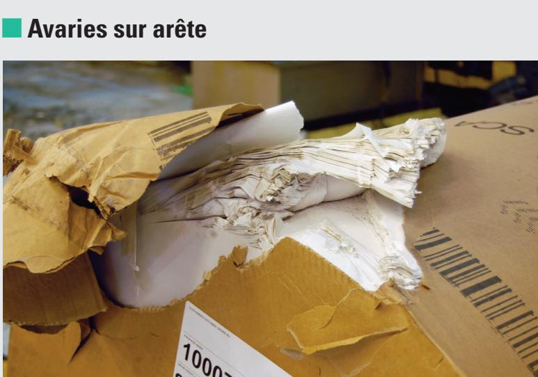
La bobine a été déposée ou traînée sur des gravillons, ou tout autre débris, pendant le transport. Elle a aussi pu être déposée inclinée sur le sol.
