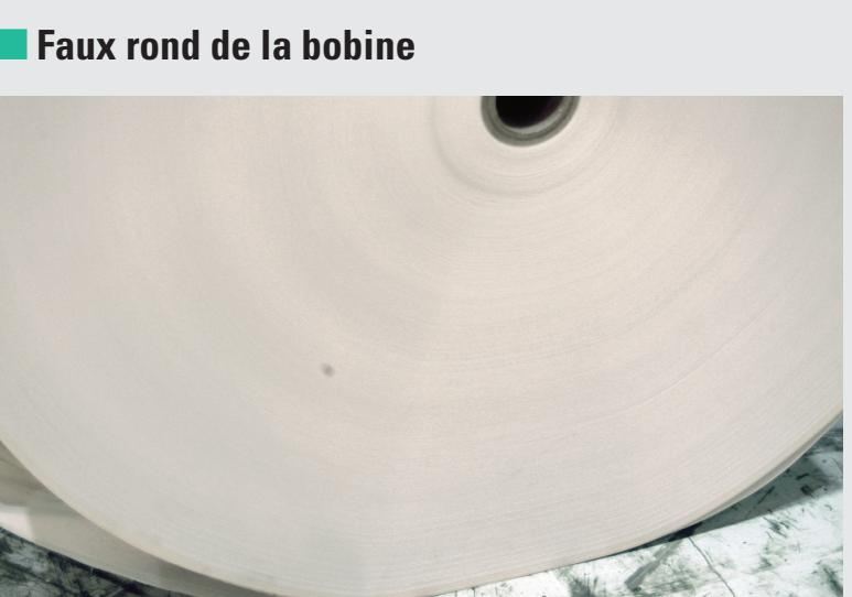
La bobine a reçu un impact pendant le transport ou a été stockée trop longtemps en position horizontale. Ceci peut également être dû à une trop forte pression de serrage des pinces du chariot élévateur.
