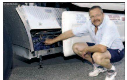
*El rendimiento medioambiental y económico del transporte por carretera se puede mejorar. Mediante una unidad auxiliar de potencia diesel para calentar y enfriar la cabina del camión se evita el funcionamiento del motor durante los tiempos en que el camión está aparcado y se reducen el consumo de combustible alrededor del 80%, las emisiones de carbono y los niveles de ruido. Foto: Quad/Graphics.*
