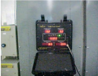
Una medición exacta permite a las empresas evaluar los ahorros potenciales y verificarlos. La mejor forma de escoger un sistema de iluminación industrial consiste en determinar su consumo eléctrico midiendo la potencia eléctrica de los sistemas de iluminación y multiplicarla por los lúmenes difusos que se precian en el espacio de trabajo. Foto: Orion Energy Systems, WI, Estados Unidos.
