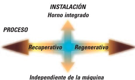
Existen dos opciones de instalación para incineradores en líneas de offset heatset. Puede ser una unidad independiente o un incinerador integrado en el horno de la máquina. Existen dos opciones de proceso, cada uno de ellos con una eficiencia energética diferente.
