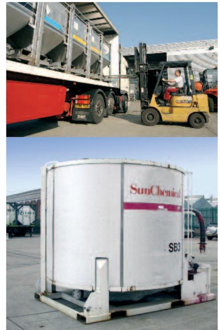
**Conviene utilizar los mayores contenedores posibles de tinta para minimizar la limpieza, el transporte y los costes de compra. Entre los sistemas de entrega disponibles están los bidones, los depósitos, las bolsas de fluido y los depósitos sobre el suelo o bajo el suelo para su relleno. En algunos casos, se pueden precisar contenedores secundarios para limitar el riesgo de pérdidas y salpicaduras. Foto: Sun Chemical.**
