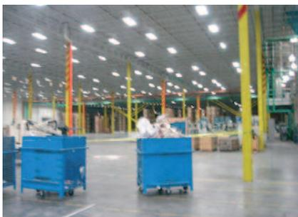
Quad/Graphics ahorró 3,5 megavatios de electricidad al sustituir 14 000 puntos de iluminación en sus 24 plantas por sistemas de fluorescentes T-8 provistos de control electrónico y con diseño óptimo de reflector de manera que se obtuvo un 50% más de luz y se redujo el consumo eléctrico en un 52%. Esto dio un retorno de la inversión de menos de dos años. Foto: Orion Energy Systems, WI, Estados Unidos.
