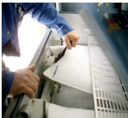
Un nuevo diseño de filtro con una mayor área superficial parece que ofrece una vida de tres a seis veces más larga en el filtrado y de dos a cuatro veces de mayor duración de la solución de mojado. Foto: Technotrans softflow.
