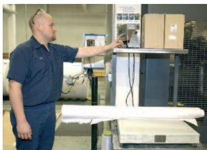
**Medir los desperdicios para controlarlos. Este impresor está comprobando una muestra de las primeras vueltas de una bobina de papel para saber el peso del desperdicio.**
