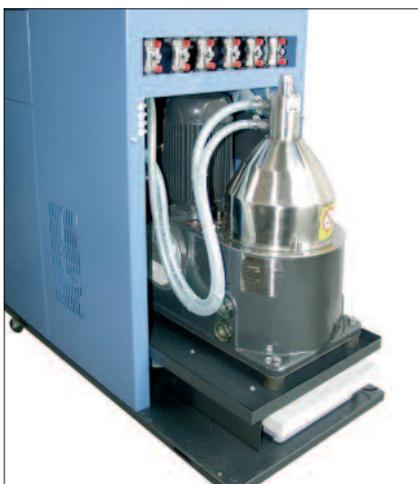
*Sistema de limpieza del procesador de planchas utilizando un nuevo procedimiento de limpieza sin filtro que emplea fuerzas centrífugas dentro de un tambor rotatorio. Foto: Spinclean CTP de Tecnotrans.*
