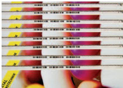
Die Barcode-Erkennung, bei der ein auf den Falzbogen angebrachter Barcode gescannt wird, ist die zuverlässigste Methode zur Überprüfung der Produktzusammensetzung. Mit dem ASIR-System kann die korrekte Bogenreihenfolge überprüft werden. Exemplare, die nicht mit dem gescannten Barcode oder vom Bediener eingestellten Barcode/Bildausschnitt übereinstimmen, werden ausgeschleust. Foto: Muller Martini
