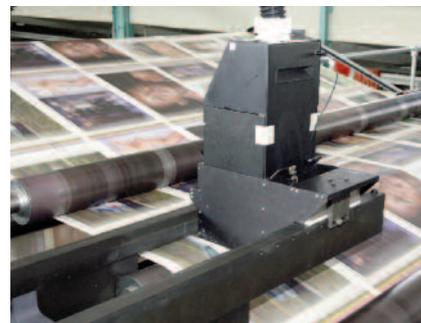
Tintenstrahl-Drucksysteme können einfach mit Rollenoffset-Druckmaschinen und Weiterverarbeitungsanlagen integriert werden. So können Druckereien ihre vorhandenen Anlagen bestmöglich nutzen, indem sie mit Direktmarketing- und anderen Aufträgen Mehrwert generieren und ihre Geschäftsmöglichkeiten erweitern. Foto: Kodak
