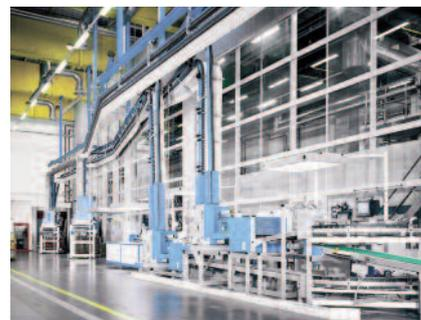
*Ein Überkopf-Fördersystem ermöglicht eine flexible Anordnung, die vor allem bei engen Platzverhältnissen und beim Überbrücken großer Distanzen und zur Verbindung verschiedener Gebäudeetagen wichtig ist. Einige Systeme können mit bis zu drei Schuppenströmen mit einer Kette transportieren.*
