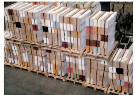
Schlecht gestapelte Paletten können die Qualität der Falzbogen beeinträchtigen und stellen zudem ein Unfallrisiko dar. Das Foto zeigt, dass die Umreifung an den Stangen auf der unteren Palettebene gedehnt wird. Dadurch wird die zweite Palette von rechts instabil.
