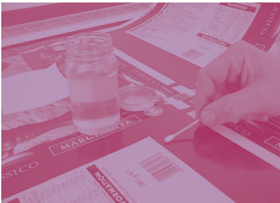
Bei der traditionellen Prüfmethode für die Durchrocknung der Druckbogen wird die Lösemittelbeständigkeit eines gedruckten Musters gegen eine Standardprobe verglichen.
