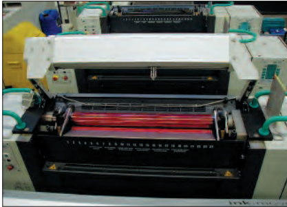
Geöffnete Farbkastenhaube mit Blick auf Farbkastenverrührer. Er verhindert, dass hochviskose UV-Druckfarbe in den Kästen stehen bleibt. Foto: manroland.
