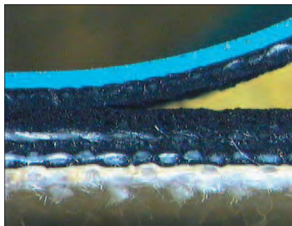
Um das Abziehen zu erleichtern, sollten Gummitücher aus kompressiblen Schichten mit offener Zellenstruktur verwendet werden. Foto Trelleborg.
