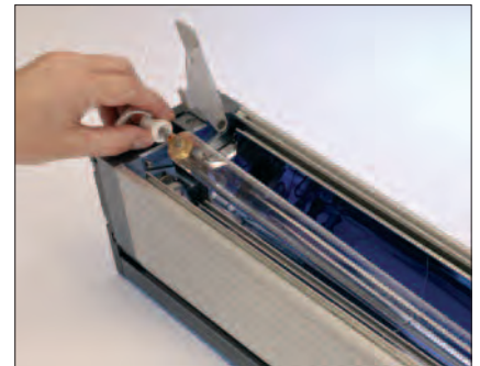
UV-Module mit Einsteck-UV-Lampen für einen schnellen Lampenwechsel ohne Werkzeug.
