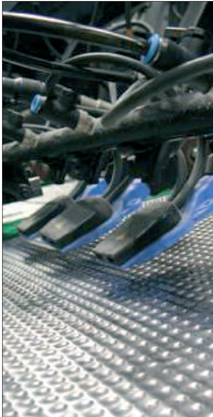
Saugbändertisch mit speziellen Conidur-Blechen und Blaslüfterzeugern zur Bildung eines Luftkisseneffekts erleichtern den Transport oberflächenempfindlicher Bedruckstoffe.
