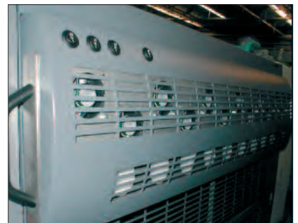
Farbwalzenblaseeinrichtung kombiniert mit Farbnebelabsaugung.
