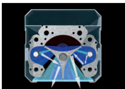
Ein neues Trocknerkonzept kombiniert zwei UV-Lampen in einem Modul, um Wärmeprobleme zu eliminieren, die mit IR-Energie verbunden sind. Quelle: Eltosch.
