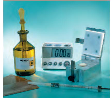
ACET ist ein einfach anzuwendender und von der Fogra entwickelter Test für die Lösemittelbeständigkeit.
