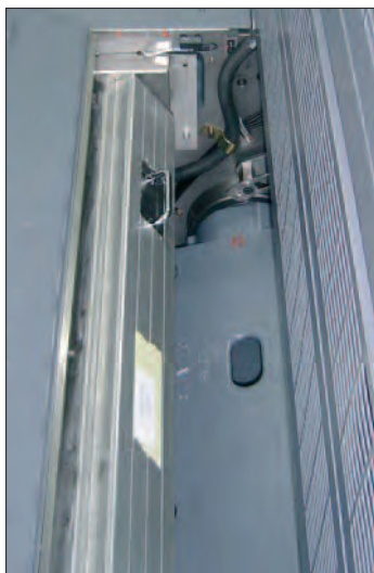
UV-Zwischentrockner auf einer ROLAND 700 Druckmaschine. Foto: Eltosch.
