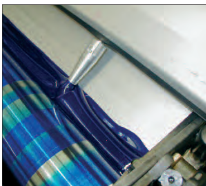
Bei hochviskosen UV-Druckfarben, die zum Stehenbleiben im Farbkasten neigen, empfiehlt sich ein Farbverrührer. Quelle: manroland.
