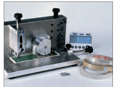
Der Fogra LHT-Klebebandtest für die Kratzfestigkeit bestimmt die Werte automatisch.
