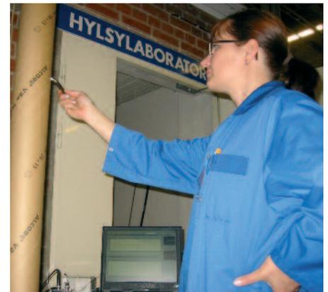
Qualitätsprüfung des E-Moduls - ein hoher E-Modul und eine niedrige Dichte reduzieren das Risiko eines Hülsenbruchs. Foto Sonoco-Alcore.
