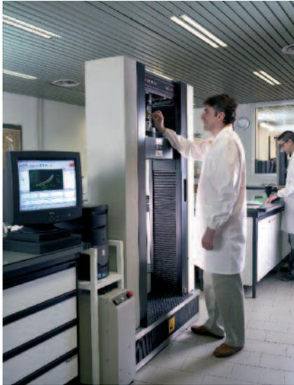
Gummidrucktücher Test der kompressiblen Schicht. Foto Trelleborg.
