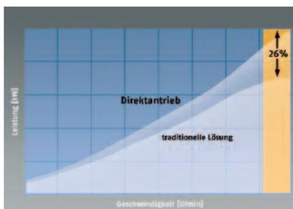
Direktantriebe sind effizienter als Gleichstrommotor-Lösungen. Quelle: Baumüller.
